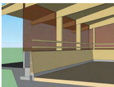
▲ Exempel på sarg med sockel av betong och skyddsrännan vid pelare.
