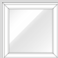
Fast fönster med dubbelkarm ej öppningsbart
